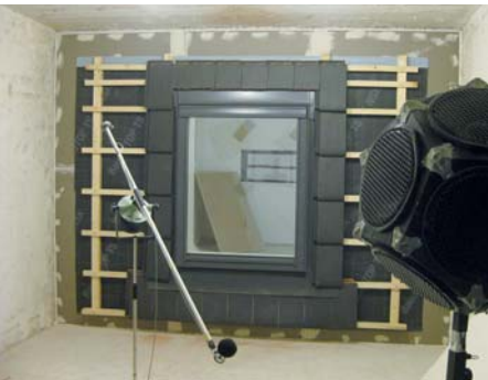
Schallschutz-Tests in der Versuchsanstalt TGM (Vertikaler Einbau gemäß Prüfnorm für Fenster)
